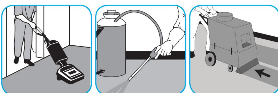
Pase primero la aspiradora por la alfombra. Llene el tanque de solución del extractor con Extraction SC del dispensador. Si fuera necesario, haga una eliminación de manchas previa con un eliminador apropiado. Realice la extracción de acuerdo con las instrucciones de operación del fabricante del equipo.
