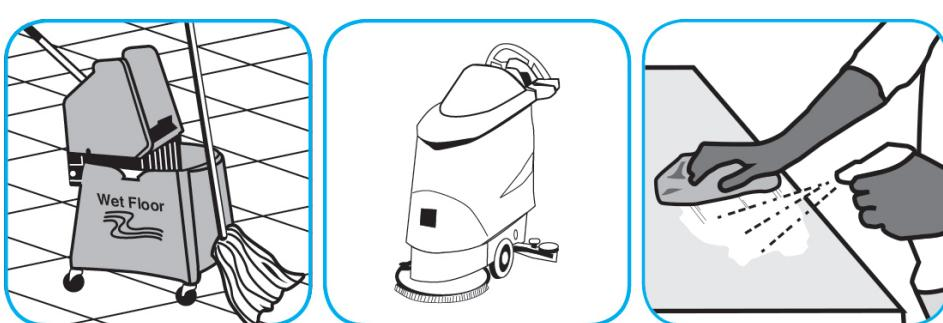
Diluya con agua fría. Para la limpieza diaria, use una botella con atomizador, un trapeador y cubeta o llene la máquina de fregado y use discos rojos. Para fregado en profundidad, llene la máquina de fregado y use discos verdes o azules. Recoja la suciedad y el exceso de limpiador con un trapeador de limpieza o paño bien retorcido.
