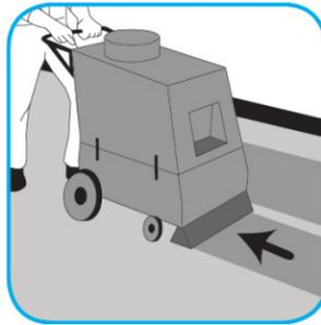
Pase primero la aspiradora por la alfombra. Llene el tanque de solución del extractor con Extraction SC del dispensador. Si fuera necesario, haga una eliminación de manchas previa con un eliminador apropiado. Realice la extracción de acuerdo con las instrucciones de operación del fabricante del equipo.
