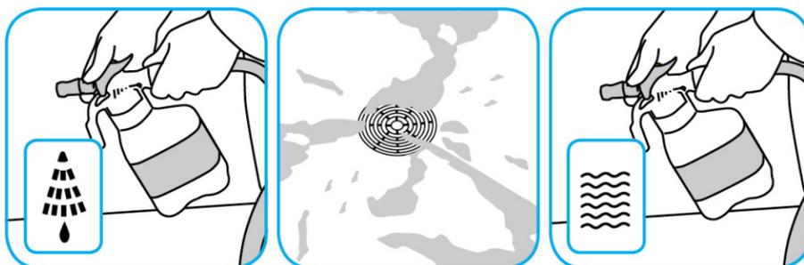
Tourner le bouton de sélection en position de vaporisation élevée. Vaporiser le drain de 2 à 10 secondes, selon la taille du drain. Laisser agir durant 30 secondes maximum. Tourner le bouton de sélection en position de rinçage. Rincer abondamment le drain.
